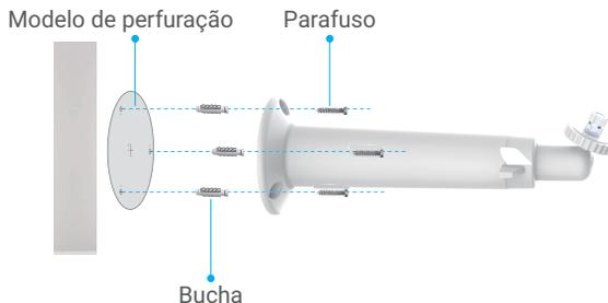
**i** Quando fizer os furos para os parafusos de expansão, certifique-se de que o diâmetro da cabeça da broca é de 5,5 mm a 6 mm e a profundidade do furo não é inferior a 25 mm.
